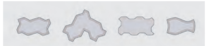
Abb. 77: Steinformen für lagerstabile Pflasterflächen.
